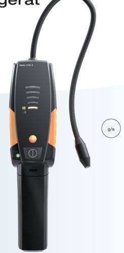
testo 316-3 ist ein zuverlässiges Lecksuchgerät für Kältemittel das in einer professionellen Kältetechnik-Ausrüstung nicht fehlen darf. Es entdeckt selbst kleinste Lecks dank seiner hohen Sensitivität von 4 g/a und erfüllt damit die Vorgaben der F-Gase-Verordnung sowie die gängigen Normen SAE J1627 und EN14624:2012.
